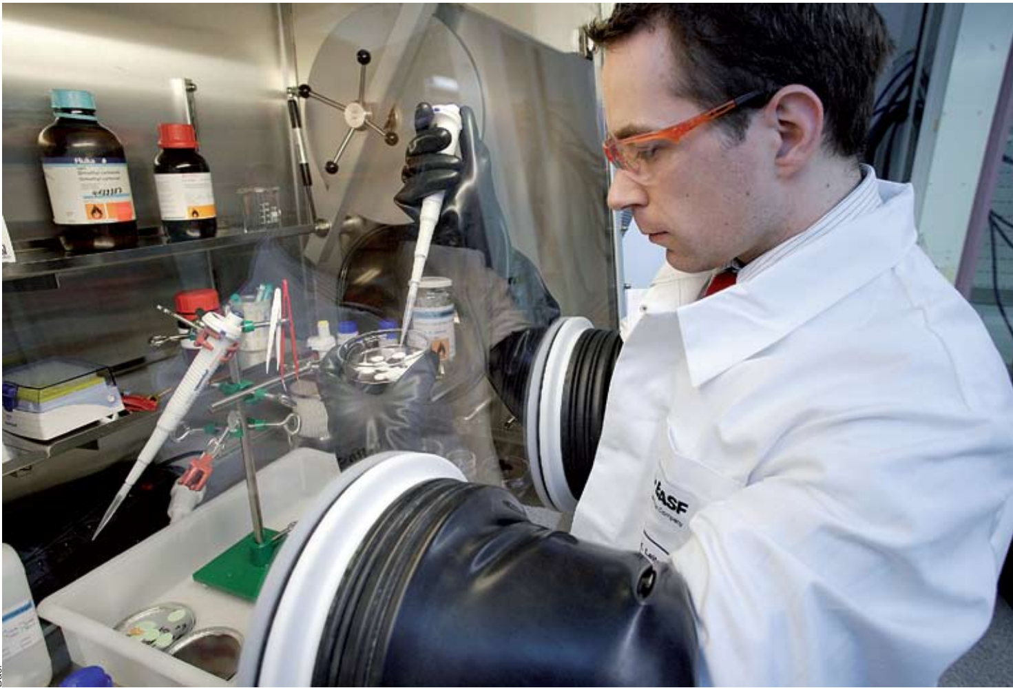
Akkujen ja erityisesti niiden katodimateriaalien valmistus on suurta puhtautta edellyttävää nanotekniikkaa. Niinpä tuotekehityksessäkin on käytettävä puhdistilaa, jonka vakiovarusteena ovat erikoishansikkaat.
