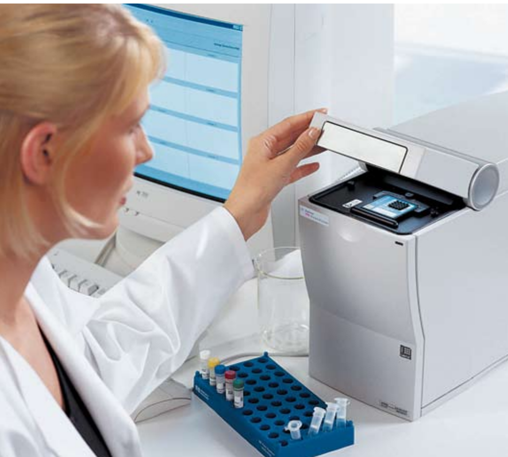
Laboratorio kutistuu mikrosirun kokoiseksi. Jo vuonna 1999 esitelty Bioanalyser Chip sopii dna- ja rna-analytiikkaan.
