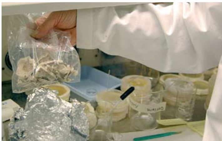
Helsinki-läiskoulun seinästä kerätty kipsimururinäyte.
