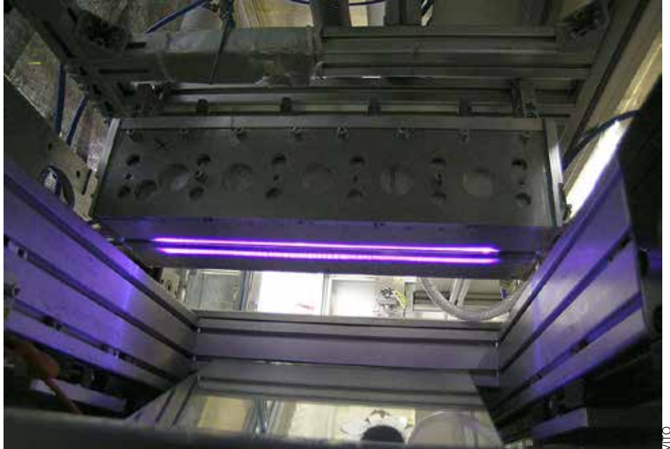
Normaalissa ilmanpaineessa toimiva plasmalaitteisto on belgialaisen tutkimuslaitoksen VITO:n kehittämä. Kuvassa näkyvä violetti väri syntyy typpi-plasmasta.
