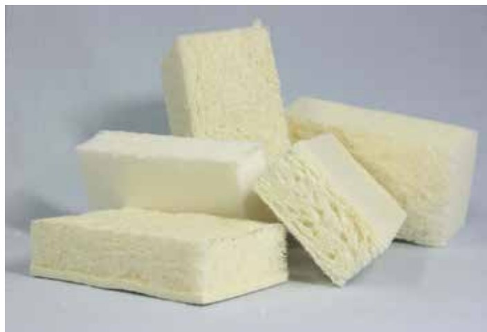
VTT:ssä valmistettuja vaahtorainattuja puupohjaisia eristelevyrakenteita.
