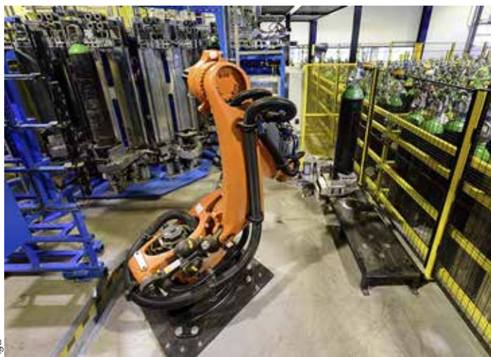
Roboteilla on muistissaan yli 200 reseptiä, joiden mukaan ne pullottavat erilaisia kaasuseoksia.
