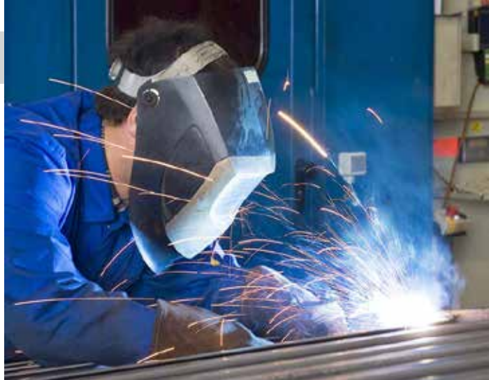
TIG-hitsauksessa muodostuu pienempiä hiukkasia kuin muissa hitsausprosesseissa.
