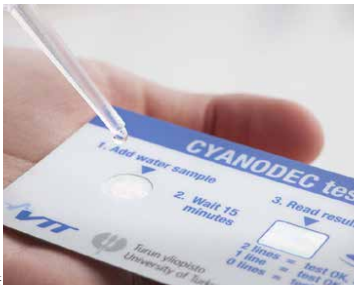
Jos näyttöön ilmestyy kaksi punaista viivaa, vedessä on sinilevämyrkkyä. Yksi viiva merkitsee myrkytöntä vesinäytettä.
