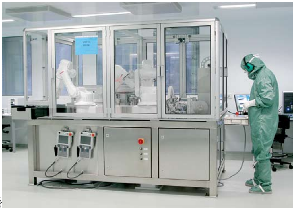
Kohdunsisäisen hormoniehkäisimen valmistus sujuu nykyisin täysin automatisoidusti. Erikoispuhdastilan robotit tekevät työtään vuorotta.
