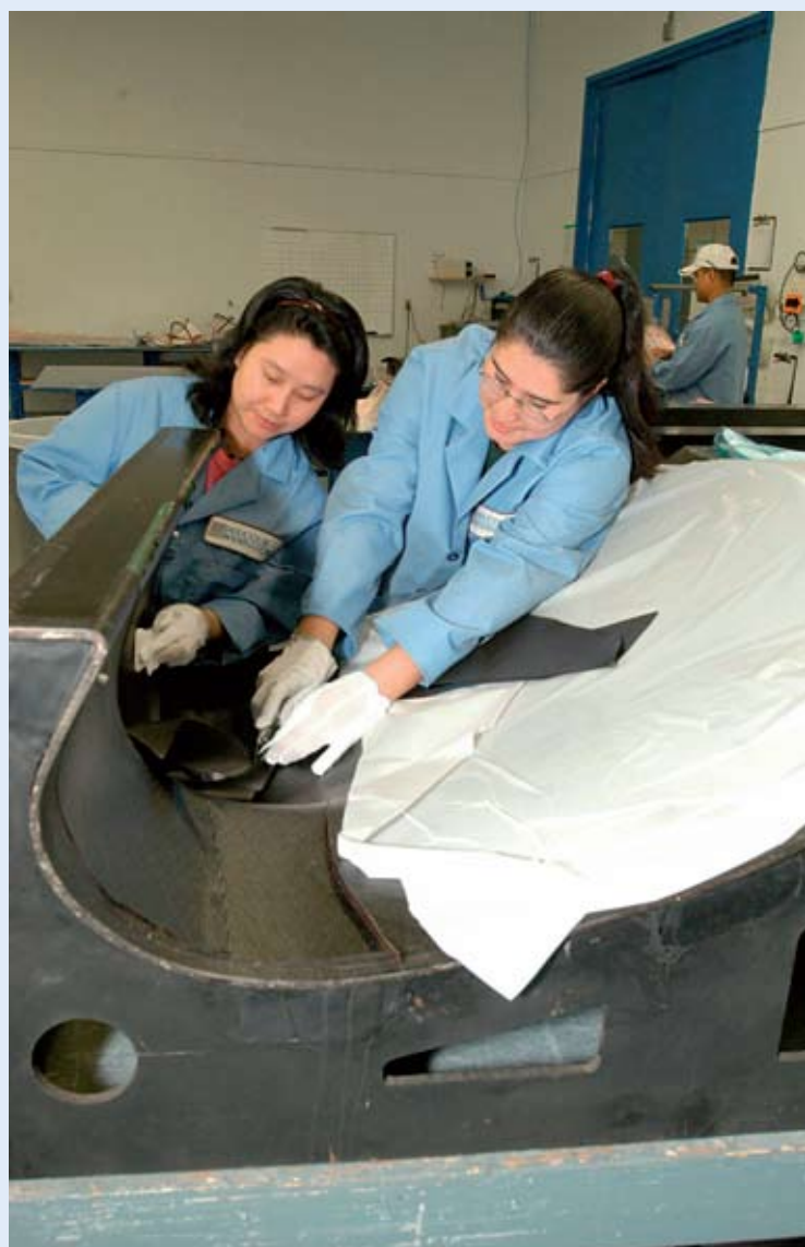
Helicombin työntekijät Soua Yang (vas.) ja Erika Ceniceros lisäävät esi-impregnaattia komposiittimuottiin, jossa syntyy kiinteitä siiven etureunan kermejä Boeing C-17:ään.
