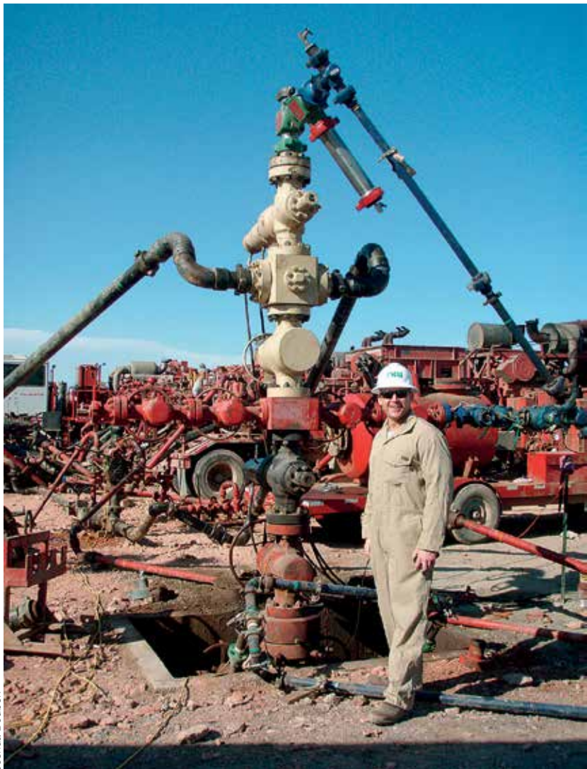
Särötysnestettä pumpataan kaivantoon Bakkenin louhoksella Yhdysvalloissa. Liuskekaasuesiintymä on maan suurin.
