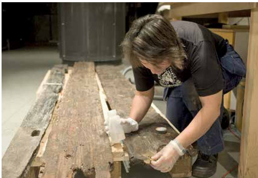
Konservoiija Emma Hocker mittaamassa Vasan lankun pH-arvoa.
