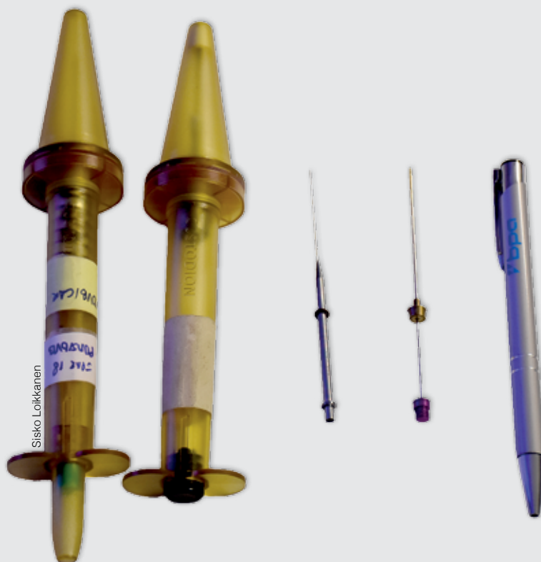
Helsingin yliopiston tutkijoiden näytteenottimia. Vasemmalta perinteinen SPME, neulaloukkumikrouutto, ITEX ja SPME Arrow. Otinten kokoa voi verrata oikealla olevaan kuulakärkikynään.
