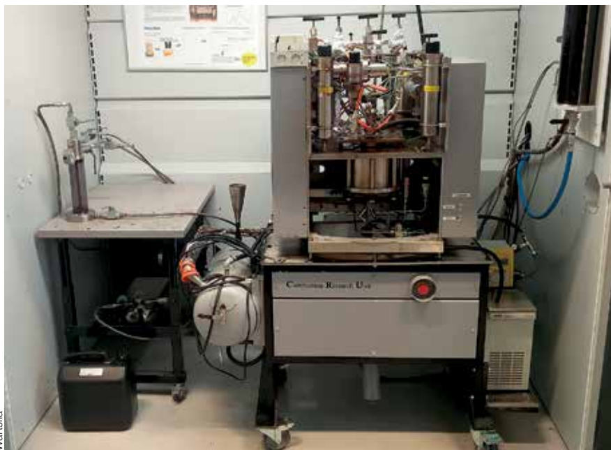
Wärtsilän laboratorion nestemäisten näytteiden tutkimuslaitteella voidaan testata myös heikosti syttyviä nesteitä.
