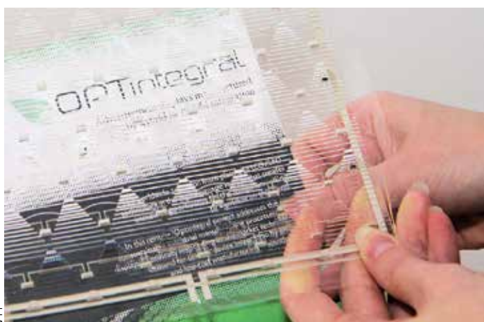
Taipuisaan valopaneeliin integroitu joustava ledikalvo osana rakennetta. Ylivalussa paneelin pintaan toteutetut optiset rakenteet ohjaavat ledeistä lähtevää valoa haluttuun suuntaan.
