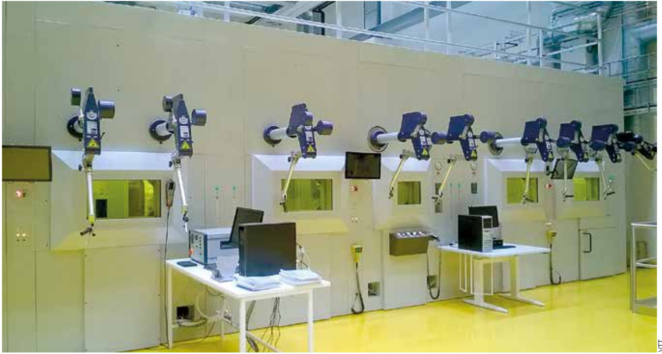
VTT:n kuumakammioissa tutkitaan säteileviä rakennemateriaaleja. Tarkoituksena on varmistaa näin ydinreaktoreiden pitkän ajan käyttöturvallisuus.
