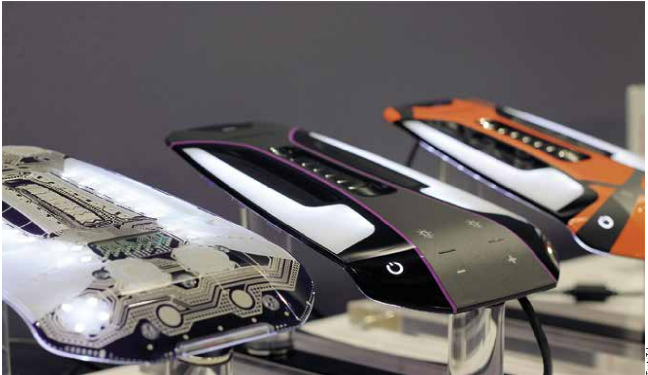
TactoTekin kehittämä teknologia kätkee elektroniikan muovirakenteiden sisälle.
