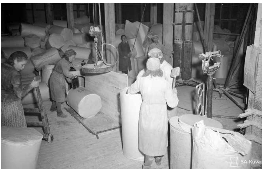
Kun tuontirehun saanti tyssäsi, Äänekosken tehtaissa alettiin valmistaa lehmillä rehua puuselluloosasta. Revittyn selluloosaan sekoitettiin kolmannes kauraa ja pari prosenttia ravintosuoloja.
